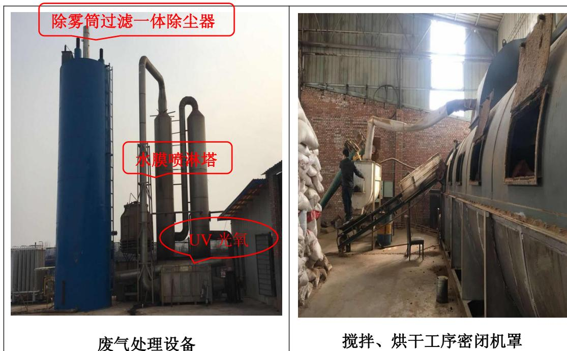
图 3-1 上料搅拌、烘干工序安装的环保设施现场照片
